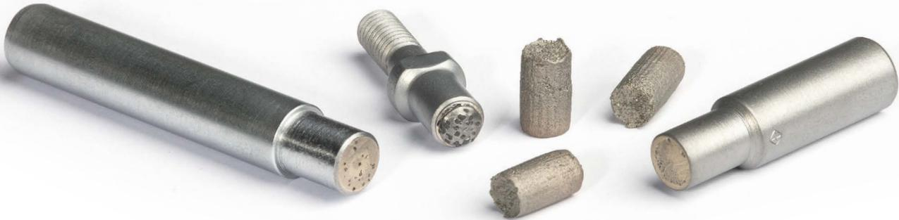
Diamantvielkornabrichter sind eine Weiterentwicklung der Mehrkornabrichter. Im Gegensatz zu den Letztgenannten sind sie nicht mit einer grösseren Zahl kleiner Naturdiamanten, sondern mit einer Schicht aus gebrochenen Diamantkörnern bedeckt. Der Vorteil von Diamantvielkornabrichtern liegt in ihrer aussergewöhnlichen Schärfe, die sich aus den zahlreichen scharfen Kanten und Spitzen der Diamant-Bruchstücke ergibt.
